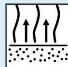
сушка 15 мин. при 20°C перед нанесением последующего покрытия
